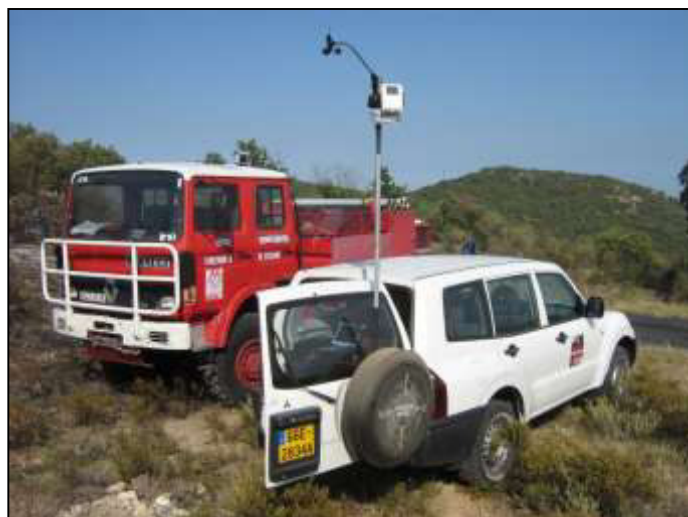
Le véhicule REX, son SIG embarqué et son mât de mesures météorologiques (source : SPFSPO)
