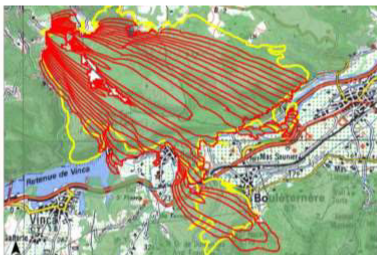
Exemple de simulation via « Farsite », comparaison avec le feu de Rodès de 2006 : contour jaune (Cellule REX)
